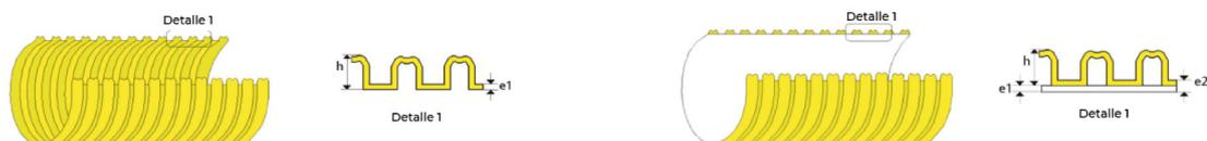
Dependiendo de la compresión requerida, los tubos se fabrican en L250 o N450. Los rollos L250 tienen una capa interior de polietileno de baja densidad (para mejorar la curvatura) y una capa exterior de polietileno de alta densidad, mientras que las barras N450 tienen una capa interior y exterior de polietileno de alta densidad.
